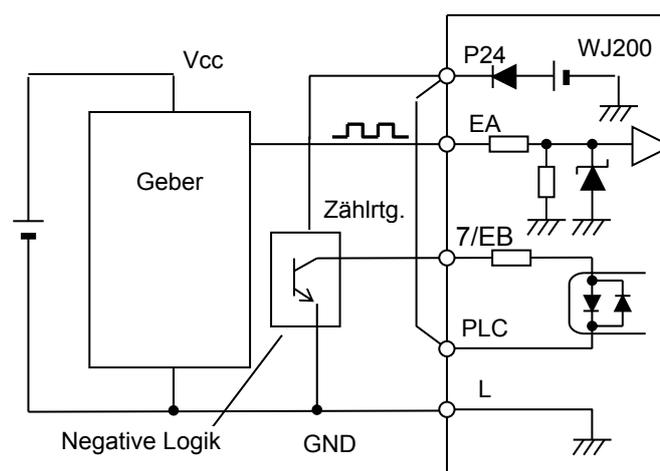
Geberspur an Klemme EA anschließen. Klemme 7 (Digitaleingang mit Funktion EB „Spur B für Inkrementalgeberanschluss“) kann in diesem Fall zur Änderung der Zählrichtung verwendet werden. Bei diesem Signal kann es sich sowohl um ein Signal mit positiver oder negativer Logik handeln. Ist der Digitaleingang angesteuert erfolgt die Zählrichtung in aufsteigender Richtung, ist er nicht angesteuert erfolgt die Zählrichtung in absteigender Richtung.
