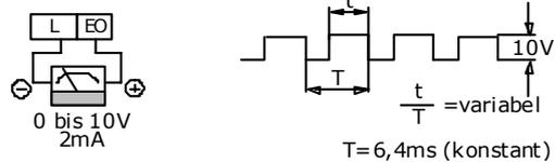
**Imulssignal für Frequenzmessgerät**
