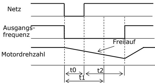
**Die Netzausfallzeit ist kürzer als die unter b002 programmierte Zeit.** Nach Ablauf von t2, Synchronisierung auf die Motordrehzahl und Hochlauf auf die Motordrehzahl
