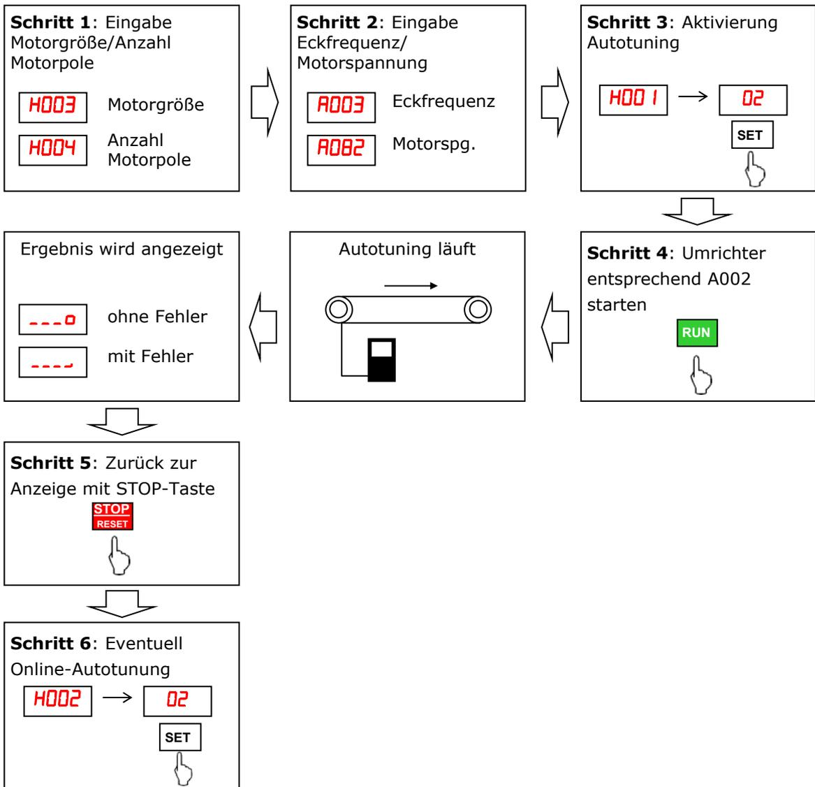
Alternativ zum dynamischen Autotuning kann **statisches Autotuning** durchgeführt werden (H001=01). In diesem Fall wird der Motor nicht drehen (eine geringe Bewegung des Rotors kann durch Beaufschlagen mit Gleichspannung trotzdem auftreten).
