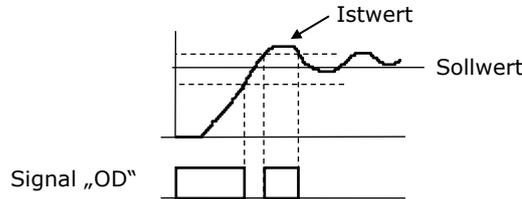
**FBV 31 PID- Istwertüberwachung C021...C026=31**
