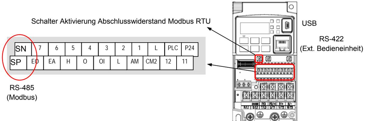
Zur Vermeidung elektrischer Reflektionen bzw. Übertragungsfehlern sollte an beiden Leitungsenden des verwendeten Kommunikationskabels ein Abschlusswiderstand verwendet werden. Mit dem entsprechenden Schiebeschalter kann am Umrichter der integrierte Abschlusswiderstand von  $200\Omega$  aktiviert werden. Die Abschlusswiderstände sollten der charakteristischen Impedanz des Kommunikationskabels entsprechen.
