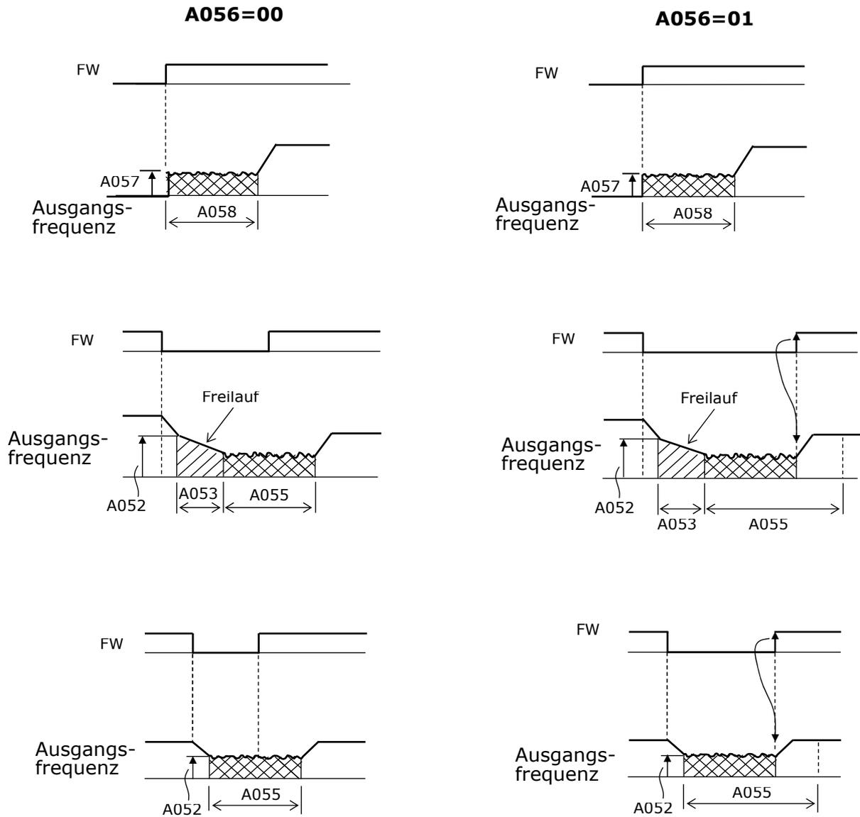
A051=02: Aktivierung der DC-Bremse wenn Frequenzsollwert=Ausgangsfrequenz < A052 und ein Startbefehl anliegt (Beispiel 1). Abschalten der DC-Bremse erfolgt wenn die Ausgangsfrequenz den Frequenzwert unter A052 um mehr als 2Hz überschreitet (Beispiel 2).
