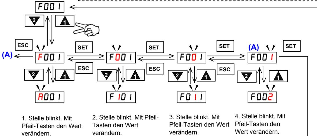
Bei Aufruf eines nicht vorhandenen Parameters, wird solange nicht in den Parameterwert gewechselt, bis ein vorhandener Parameter aufgerufen wird
