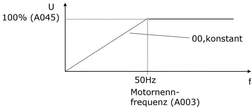
Optimierungen wie Drehmomentanhebung und Schlupfkompensation erfolgen unter Funktion A041...A047.
