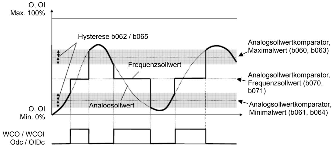
**Beispiel 1: Bei Analogsollwerten <0,5V an Analogeingang O soll Ausgang Odc gesetzt werden. In diesem Fall soll der Umrichter mit 40Hz fahren. Voraussetzung: A004=50Hz**
