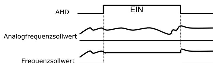
Bei AHD=EIN wird der Sollwert auch bei Netz-Aus/Netz-Ein oder Umschalten des Parametersatzes mit Digitaleingang SET gehalten.
