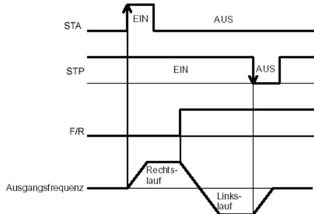
In der Grundeinstellung (Schaltlogik des Digitaleingangs „Schließer“ C011...C017=00) ist die Funktion STP wie im Bild dargestellt ein Öffner. Durch Invertierung der Schaltlogik des Digitaleingangs auf Schließer (C011...C017=01) kann STP auch als Schließer verwendet werden.
