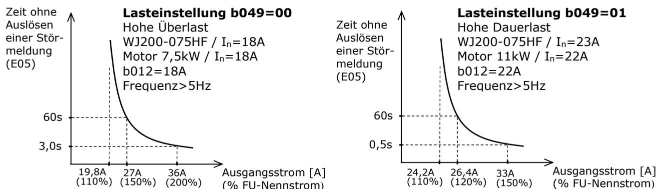
**Achtung!** Achten Sie darauf, dass der Ausgangsstrom nicht dauerhaft über dem Frequenzumrichternennstrom liegt da sonst die Lebensdauer der Zwischenkreiskondensatoren und Endstufen verringert wird.
