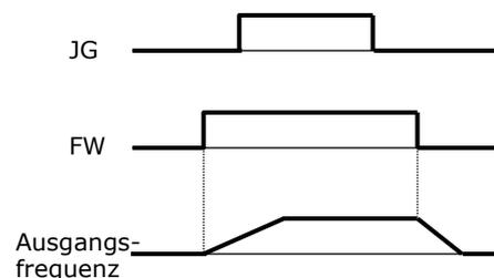
Erfolgt das Signal für den Tipp-Betrieb nachdem ein Startbefehl erfolgte, so bremst der Frequenzumrichter bei den Eingaben 03, 04 und 05 mit der eingestellten Zeitrampe auf 0Hz um dann ohne Rampe auf die Tippfrequenz zu fahren.
