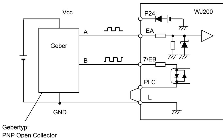
Bei einer Positionierung mit einer Geberspur, wird der Digitaleingang 7 dazu benötigt um die Zählrichtung zu ändern.
