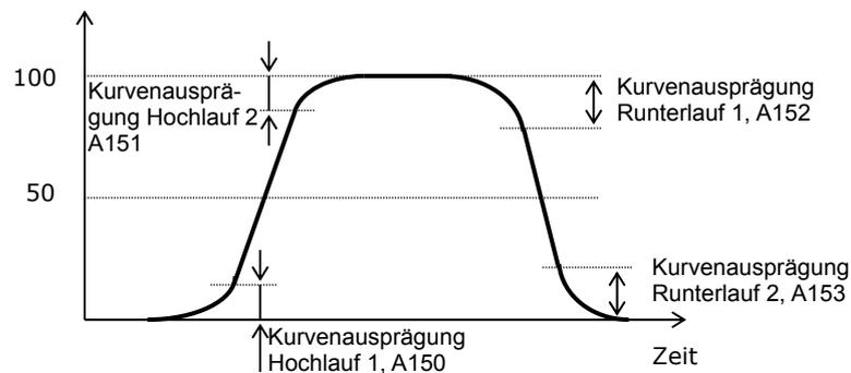
A150...A153=50%, Kurve entspricht der S-Kurve (A097/A098=03)
