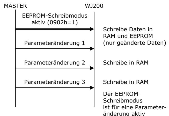
**11.1 Parameter zur seriellen Kommunikation Modbus RTU**
