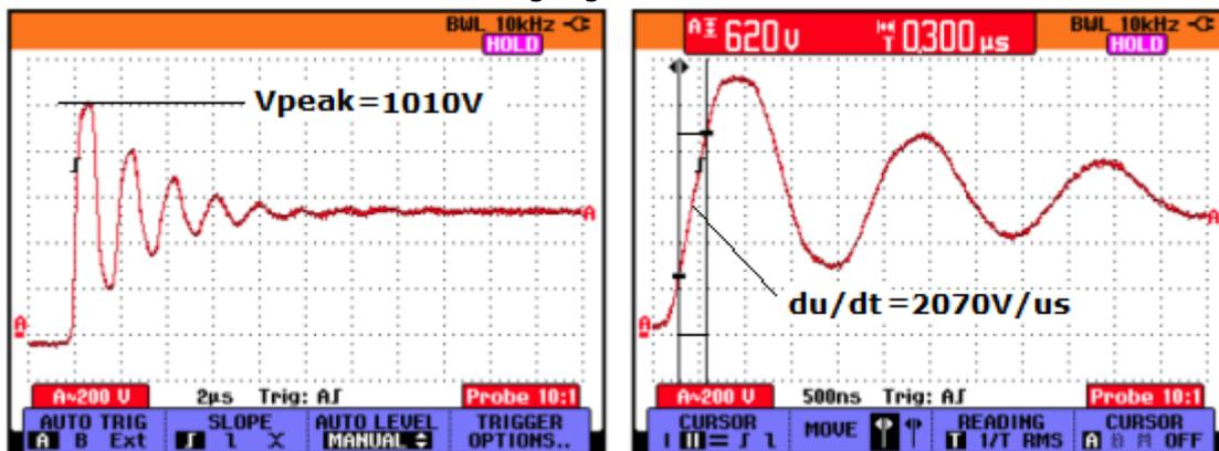
Mit Motordrossel  $0,137\text{mH}$  am Umrichter Ausgang
