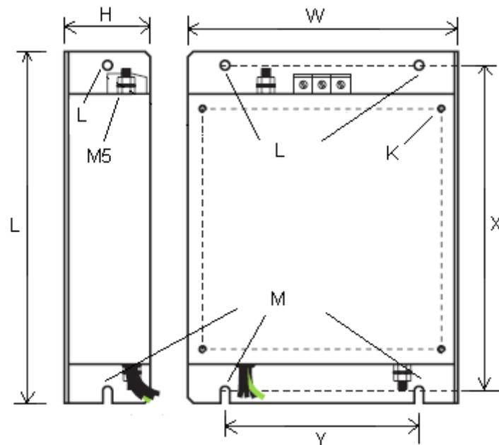
Alle Netzfilter der Baureihe FPF können sowohl als Unterbaufilter als auch als Nebenbaufilter eingesetzt werden.
