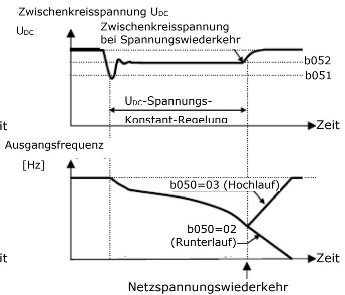
Der geführte Runterlauf kann – wenn er einmal eingeleitet wurde – nicht durch einen Start-Befehl unterbrochen werden. Zum erneuten Start, warten Sie bis der Antrieb gestoppt ist, geben Sie danach ein Stop-Signal und starten dann den Antrieb erneut.
