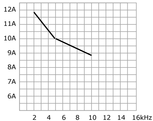
Low Duty Ub-03=01 I_{\text{nenn}}=11,9\text{A} (14,2A für 60s)
